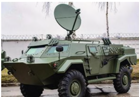
Рисунок 2 – Комплексная аппаратная связи П-240 «Кайман-КАС»
