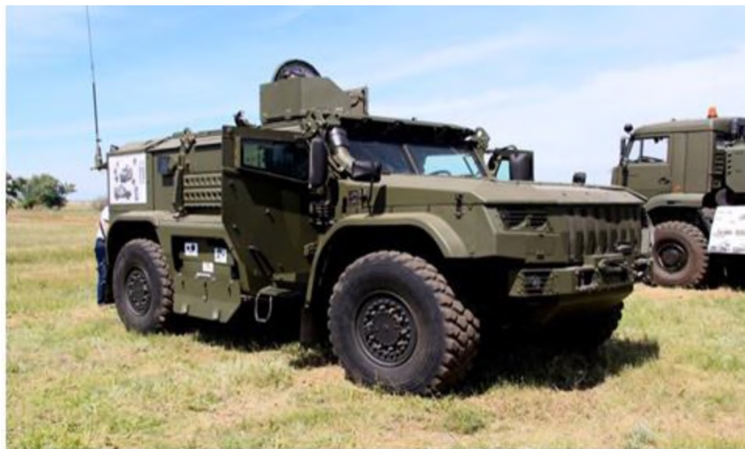
Рисунок 1 – Машина технической разведки «Тайфун»
