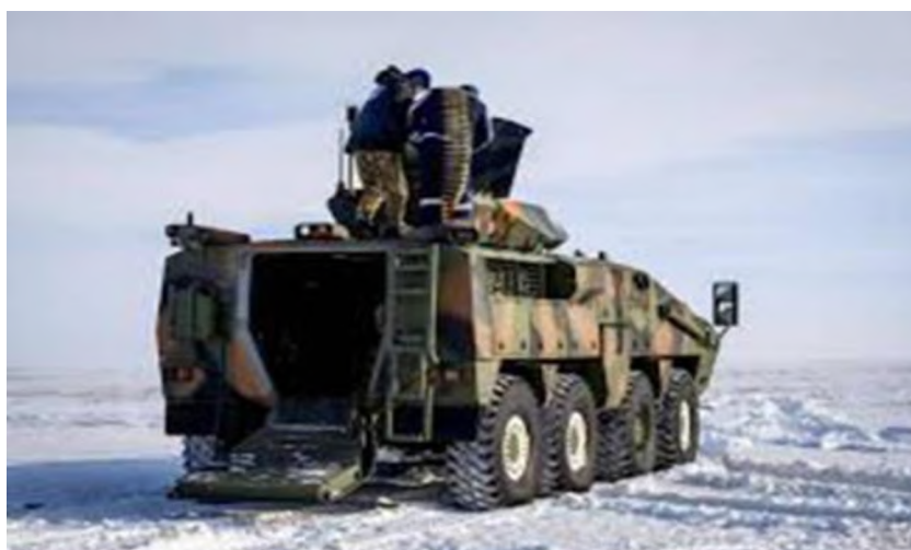
Рисунок 2 – Вариант полезной модели бронированной машины технической разведки на БKM «Барыс» - 8x8 по аналогу МТП-2
