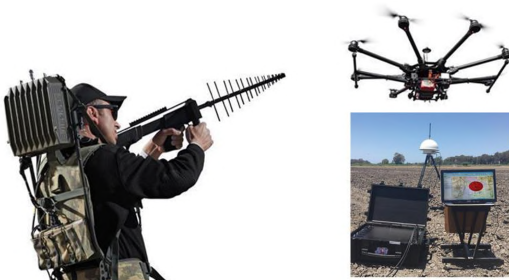
Рисунок 7 – Носимый портативный комплекс противодействия БПЛА «IHASAVAR»
