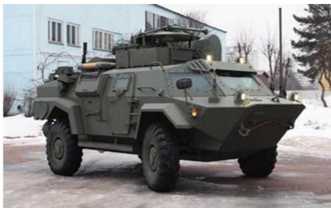
Рисунок 2 – Комплексная аппаратная связи П-240 «Кайман-КАС»
