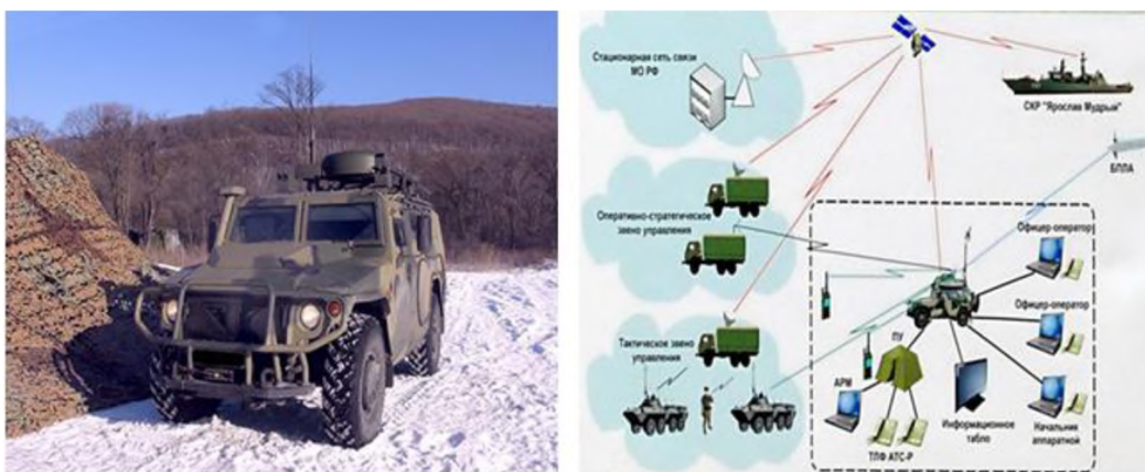
Рисунок 1 – Комплексная аппаратная связи П-230(Т) и вариант применения
