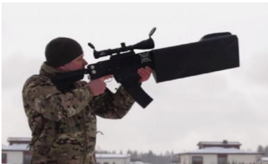
Рисунок 1 – Переносной комплекс направленного подавляющего действия «Стиллет»
